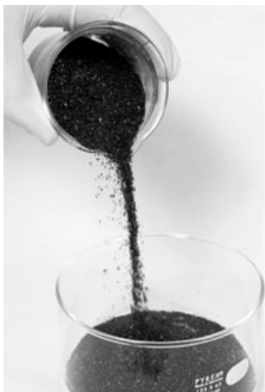
Figura 22 - Escória resfriada com água.
