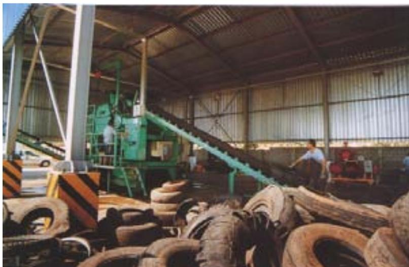
**Figura 2 – Trituração de pneus inservíveis – Jundiaí SP.**
