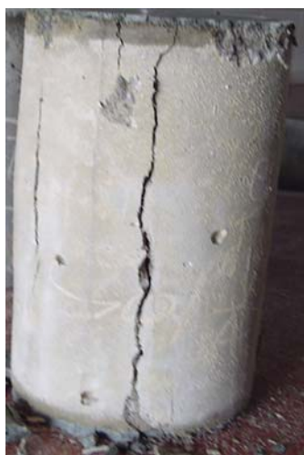
Figura 3.34 – Modo de ruptura do concreto de referência.
