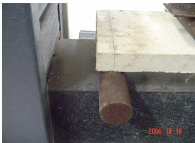
Figura 3.55 – Detalhe do apoio.
