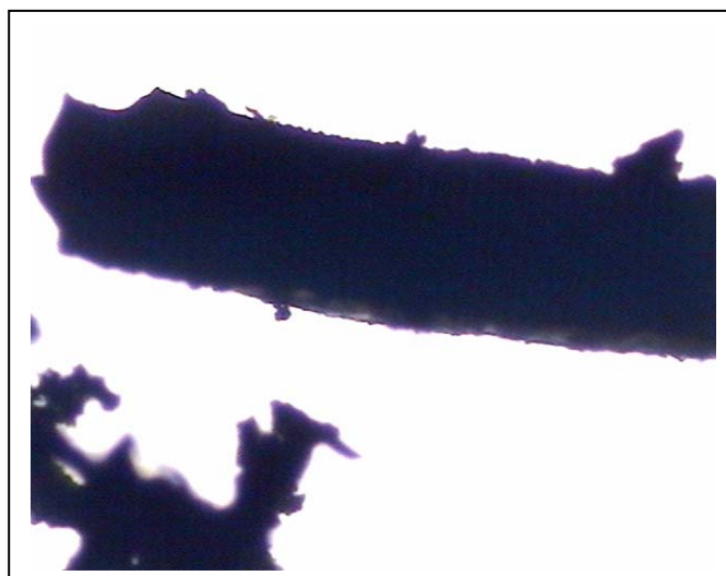
Figura 3.15 – Material retida na peneira de abertura 0,50 mm aumentado de 40 vezes.
