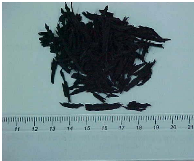
Figura 1.2 – O resíduo de borracha tem forma fibrilar.
