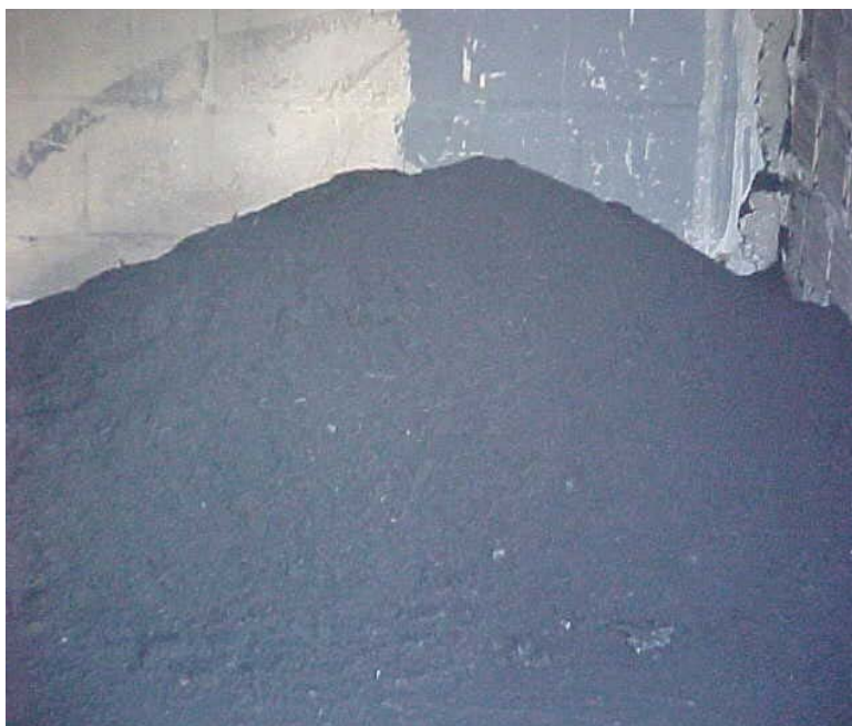
Figura 1.1 – Resíduo da recauchutagem.
