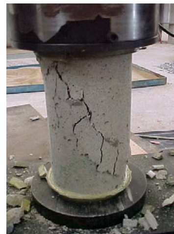
Figura 3.35 – Modo de ruptura do CAB.
