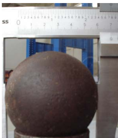
Figura 3.38 – Esfera de aço utilizada para provocar ensaio.
