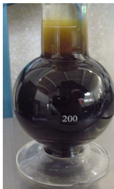
Figura 3.23 – Material com ar aprisionado.
