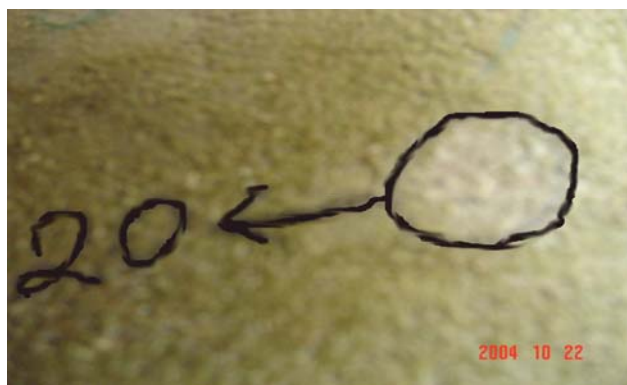
Figura 3.41 – Impacto com altura de queda 20 cm.
