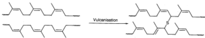
Figura 59: Vulcanização, ligações sulfídicas entre cadeias do elastómero [52].
