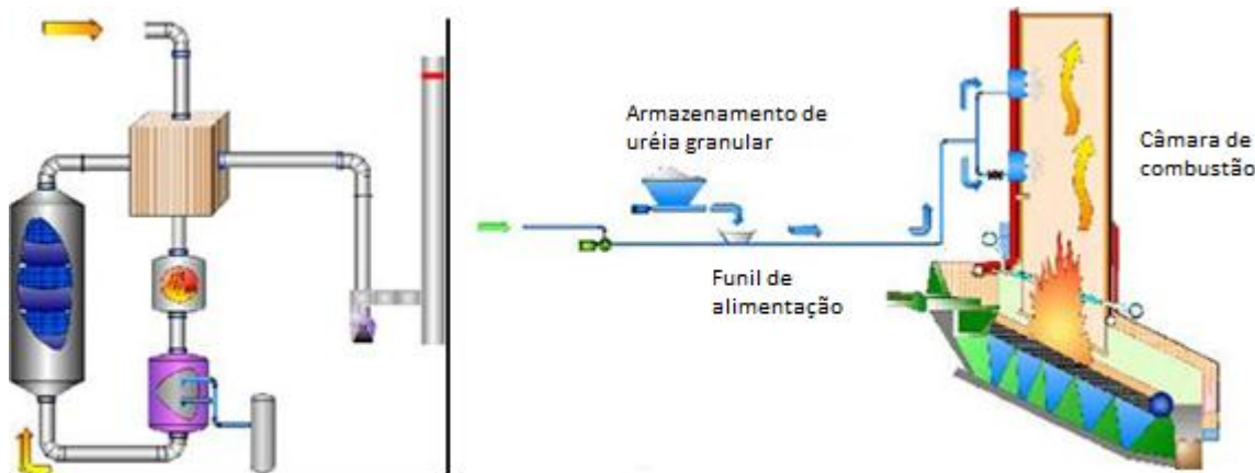
Figura – Representação esquemática dos processos de Redução Catalítica Seletiva (SCR) e Redução Não Catalítica Seletiva (SNCR).
