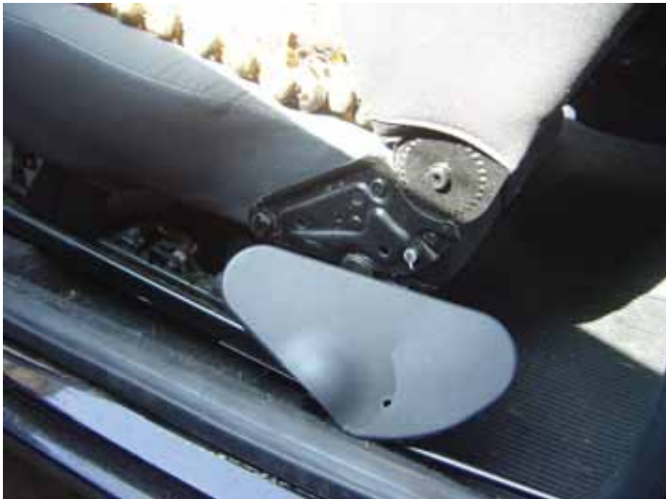
Fig. 35 – Neste exemplo, uma peça extremamente frágil danificada pelo simples uso. Essa condição favorece aos consertos improvisados.
