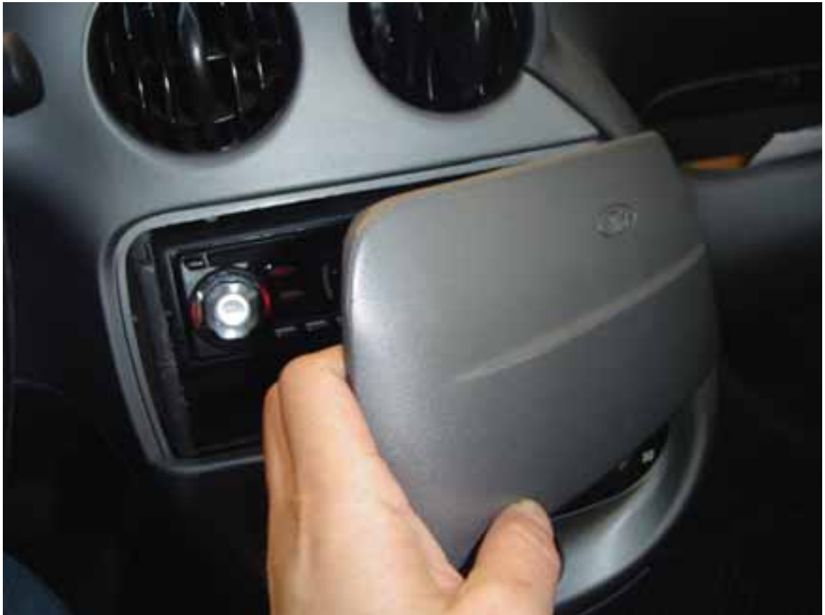
Fig. 25 – Rádio automotivo instalado de maneira alternativa ao padrão (afundado e com tampa falsa) para evitar furto.
