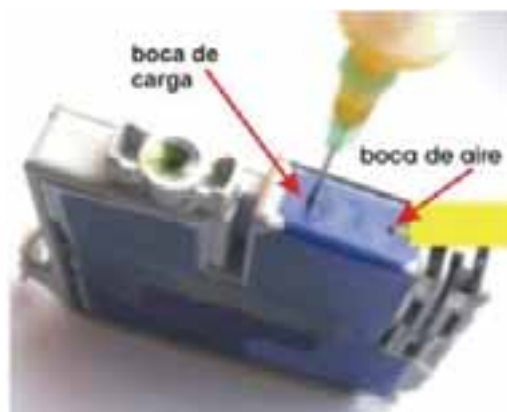
Fig. 32 – Procedimento de recarga para um cartucho de tinta. Esta prática é completamente desencorajada pelos fabricantes. Existiria algum receio na diminuição de lucros?
