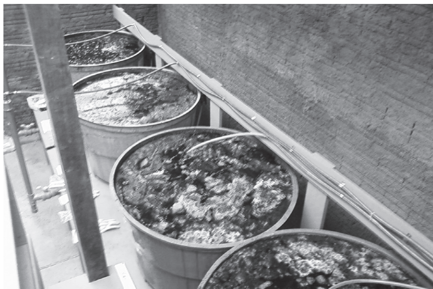
Figura 6.1 Ilustração dos filtros anaeróbios da pesquisa realizada na Unisinos.
