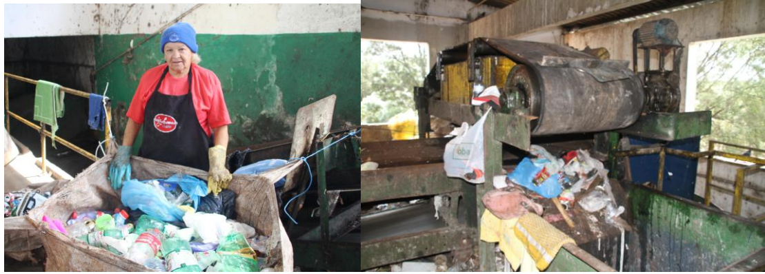
Figura 6.14 – Catadora Cleonice da Silva Pinto fazendo a triagem manual em sacos bags e por eletro imã na IRR Asa Sul Fotos: Kátia Campos Brasília – 2012
