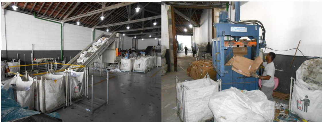
Figura 6.8 – Vista interna e prensa de papelão da IRR SOCITEX/Doe seu Lixo Fotos: COMLURB Rio de Janeiro – 2012
