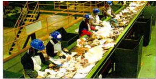
D. Em 2 linhas de catação manual/mecânica, vidros, metais e plásticos clorados são recuperados.
