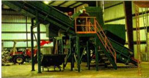
B. Do "Abridor de Sacos", o material é transferido para uma correia inclinada onde há uma plataforma para remoção manual dos não-recicláveis.
