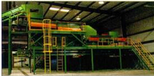
C. A "Peneira de Barras", em 2 estágios, separa os finos e orgânicos. O material restante é separado em duas frações, média e grande.
