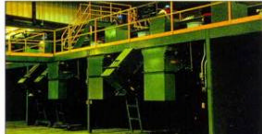
E. O material manualmente separado é jogado nos chutes que levam as correias, picando antes os vidros.
