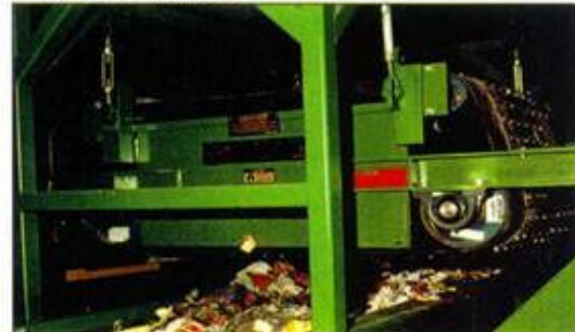
F. Materiais ferrosos são eletro-magneticamente removidos.
