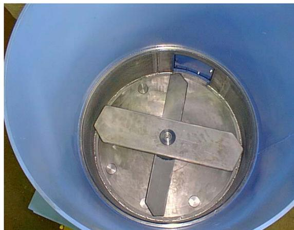
Desagregador em Batelada para Extração de fibras do rejeito
