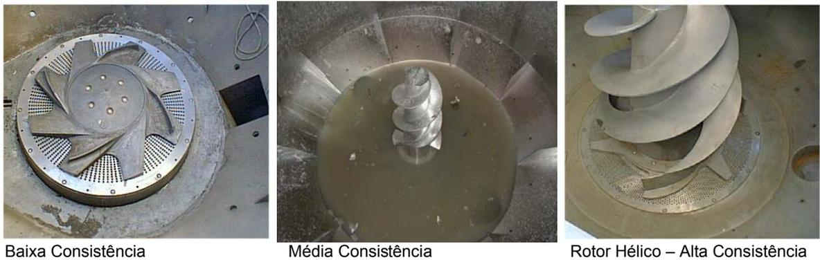
Figura 5 - Rotores sem cortes usados em sistemas em baixa, média e alta consistência para desagregação de Embalagens Longa Vida.
