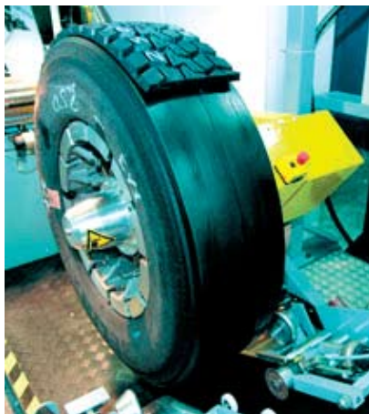
Aplicação da nova camada de borracha em processo de recauchutagem
