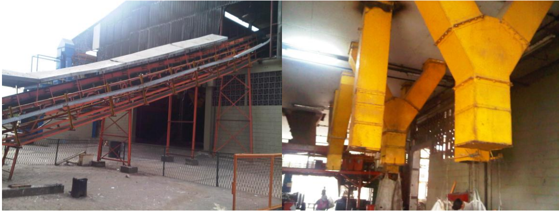
Figura 6.23– Esteira transportadora inclinada alimentadora da linha de produção e bicas de direcionamento dos resíduos do andar superior para a estocagem da IRR do Caju Foto: Kátia Campos Rio de Janeiro – 2012
