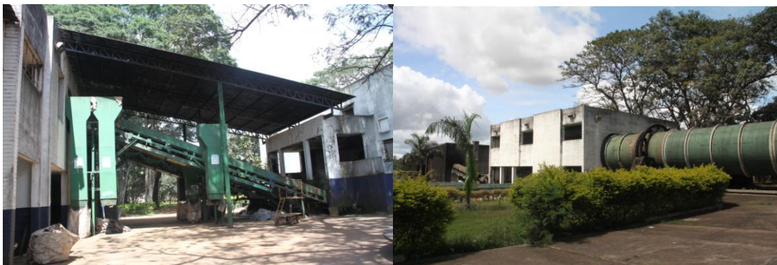
Figura 6.13 – Vista lateral dos equipamentos (esteira transportadora inclinada e biorreator) de fluxo horizontal contínuo sem retorno da IRR Asa Sul Fotos: Kátia Campos Brasília – 2012
