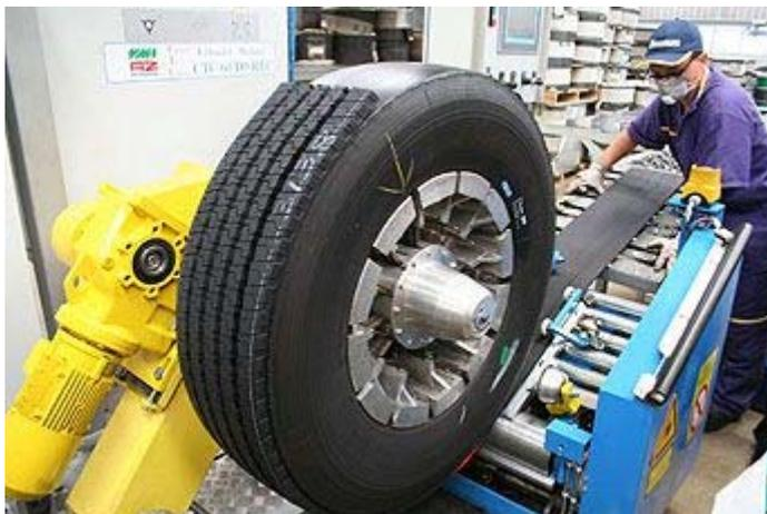
FIGURA 11. Processo de Recapagem
