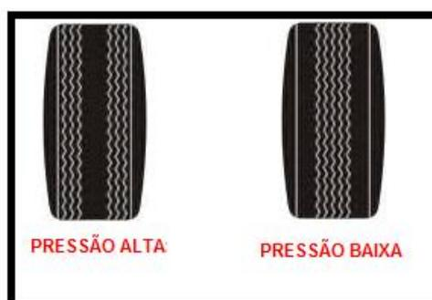
Figura 8. Desgaste de pneus ocasionado por pressão interna inadequada.
