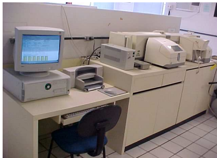
Figura 15 – Analisador granulométrico de partículas (a laser) da Malvern Instruments, modelo Mastersizer 2000 (análises entre 0.1 a 3000 \mu\text{m} ).
