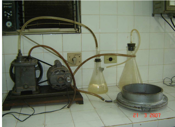
Figura 14 – Filtro a vácuo Primar (deslocamento de 48 L/min) com dois kitassatos acoplados em seqüência, e um filtro a vácuo de tela metálica B8A Denver Lab Filter.
