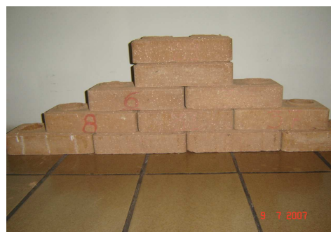
Figura 62 - Encaixe e montagem da alvenaria não estrutural
